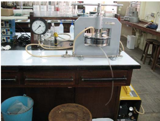
FIGURA 8. Cámara de Richards y el compresor
