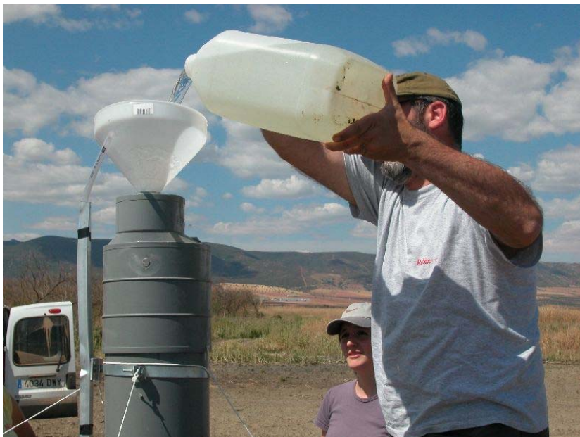
FIGURA 16. Rellenado del cilindro de inyección con la solución trazadora.
