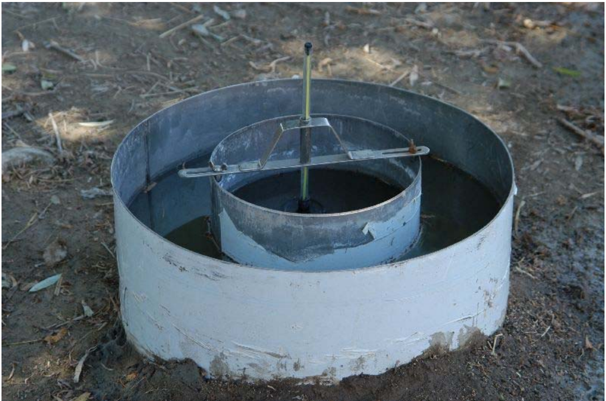
FIGURA 2. Infiltrómetro de doble anillo en funcionamiento. Se observa claramente la disposición de la regla de medida del nivel del agua y el nivel del agua en ambos anillos.
