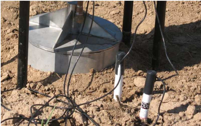
FIGURA 17. Situación típica de los sensores de humedad (TDR) en un ensayo de infiltración a carga constante
