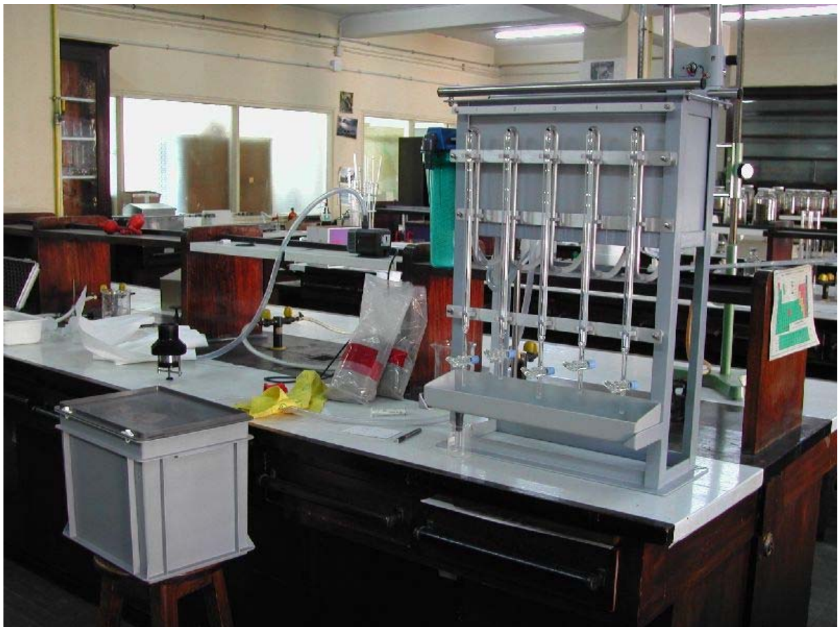
FIGURA 3. Vista general del Infiltrómetro de laboratorio instalado y de la caja que contiene la bomba del agua en circuito cerrado.
