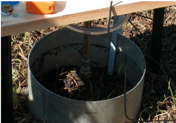
FIGURA 10. Regla de medida del nivel del agua en el cilindro de inyección.
