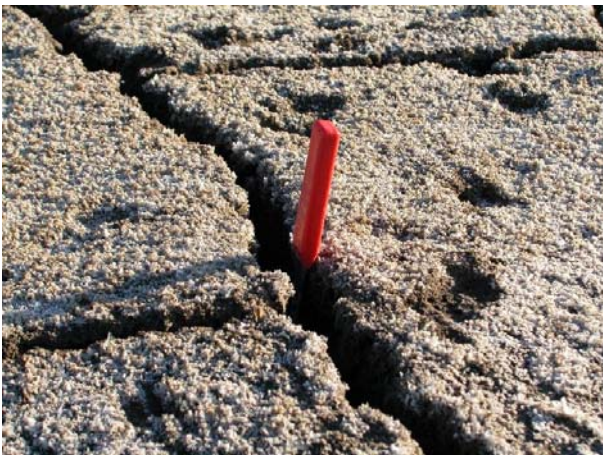
FIGURA 11. Al ubicar el dispositivo de inyección debe tenerse en consideración la presencia de discontinuidades en el terreno que puedan perturbar el ensayo, en especial es necesario evitar las
