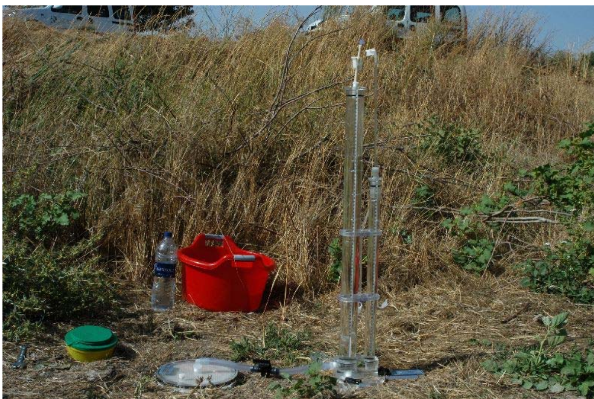
FIGURA 1. El Infiltrómetro de membrana en funcionamiento, a la derecha se puede observar el depósito del agua y el sistema para mantener la carga hidráulica constante en la membrana.
