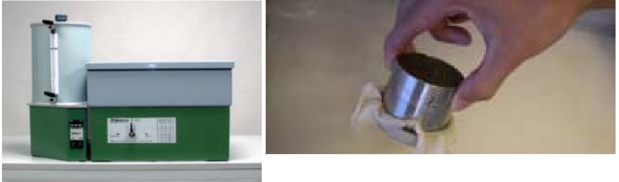
FIGURA 7. En la caja de arena o la caja de arena/caolín se introducen los anillos de muestra inalterada después de haber sido convenientemente saturados de agua.
