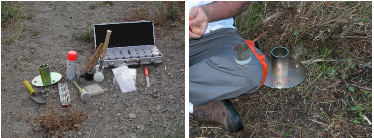
FIGURA 4. En la imagen de la izquierda se ve el equipo de muestreo y en la imagen de la derecha un momento de la preparación de una muestra ya extraída del suelo
