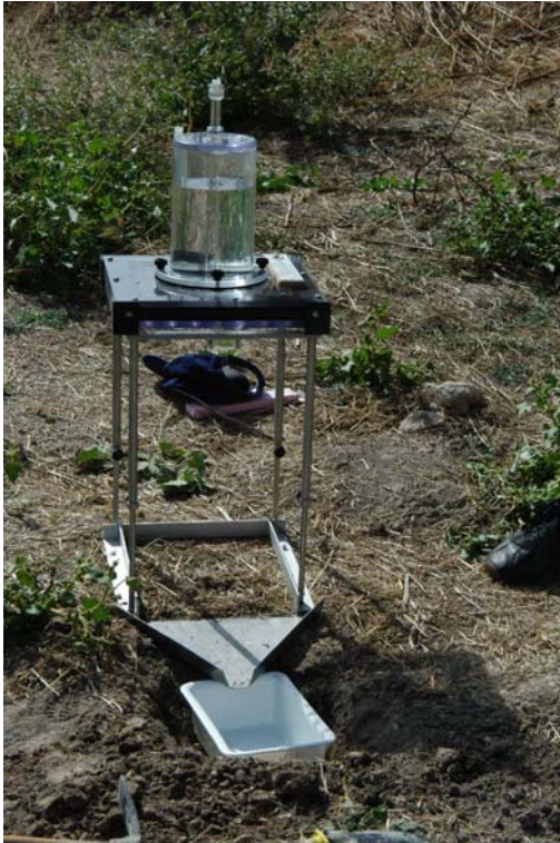
FIGURA 5. En la imagen se observa la disposición del simulador de lluvia y de la bandeja de toma de muestra de agua y del sedimento arrastrado por la precipitación.
