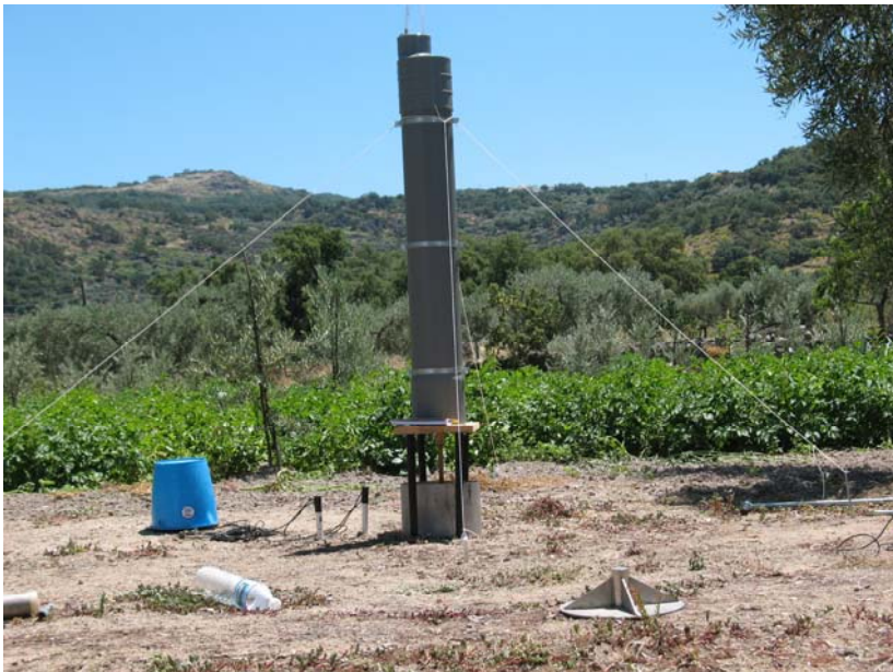
FIGURA 14. Vista general del cilindro de inyección montado y funcionando. Se puede ver, además del soporte sobre el que se instala, los tensores que le confieren una cierta estabilidad frente al viento o algún golpe accidental.
