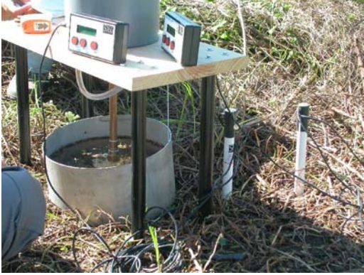
FIGURA 15. En la imagen se puede ver como la altura a la que se ajusta el tubo de salida del agua es el que determina la carga hidráulica del ensayo
